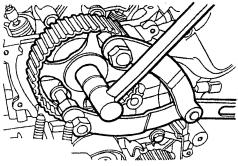
LOCKING THE CAMSHAFT SPROCKET
